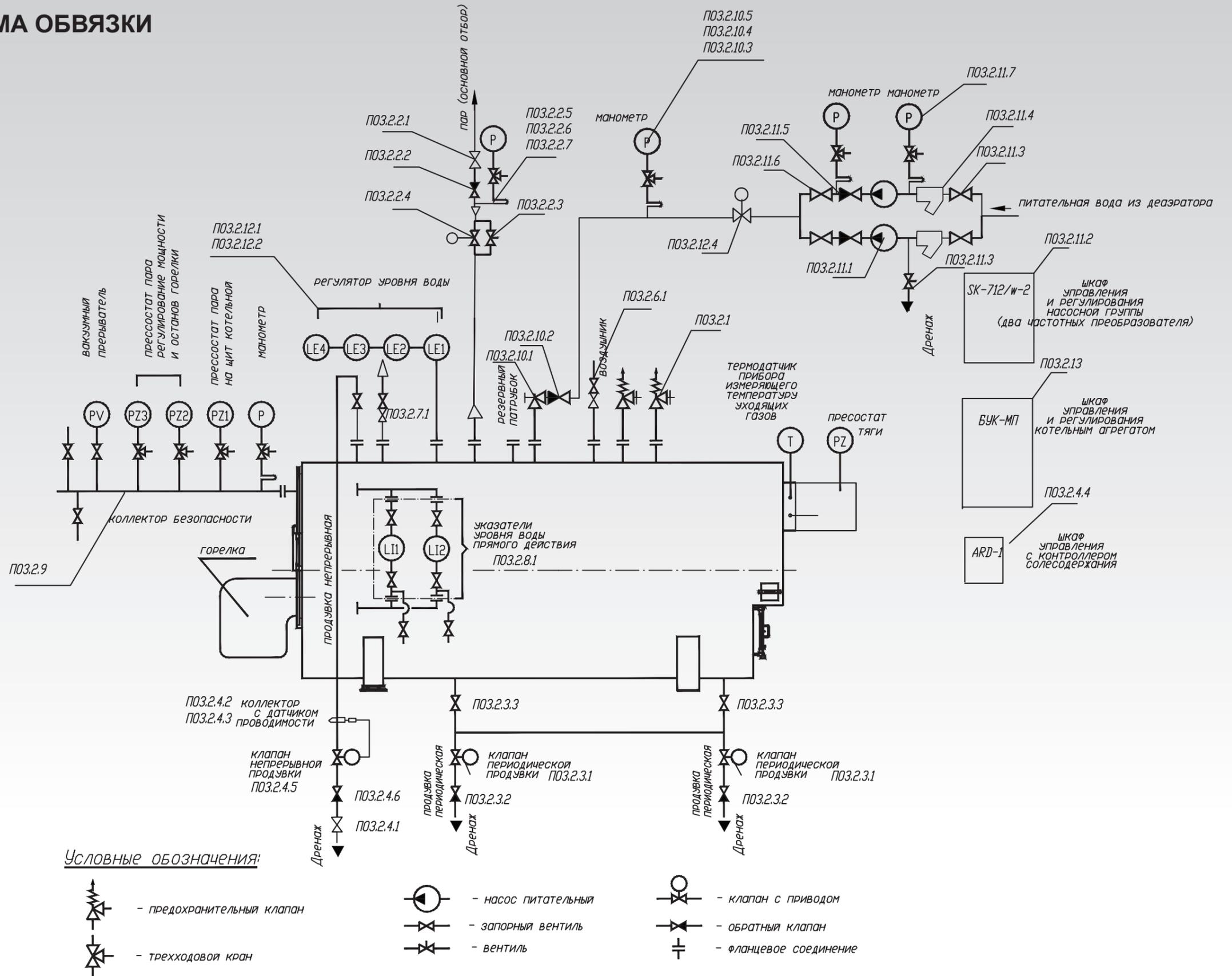
Типовая обвязка парового котла серии FR25 с автоматикой безопасности и регулирования
